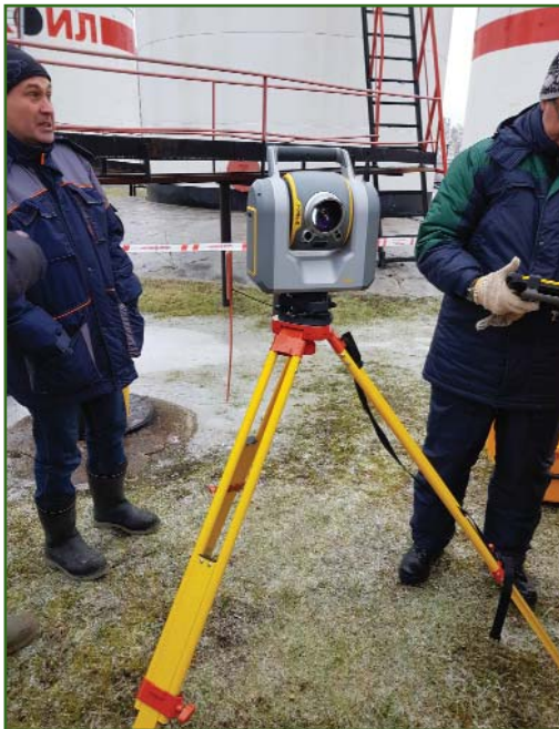
Рис. 6 Демонстрация возможностей Trimble SX10
