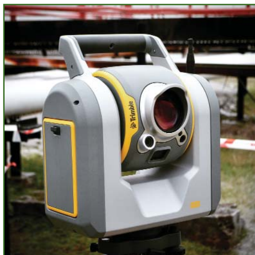
Рис. 3 Сканирование резервуара снаружи Trimble SX10
